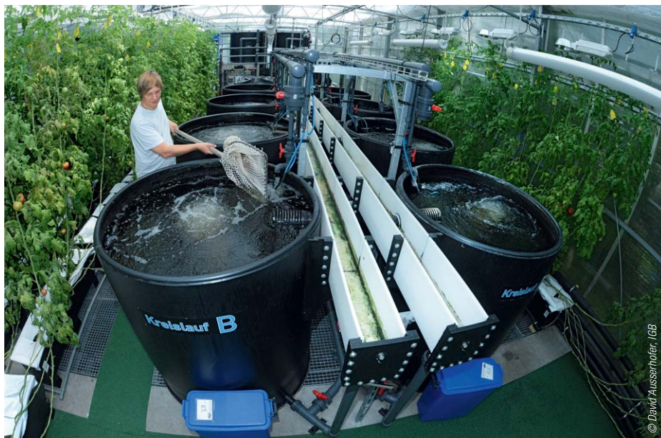
Fischtanks einer Aquaponikanlage am Leibniz-Institut für Gewässerökologie und Binnenfischerei (IGB).
